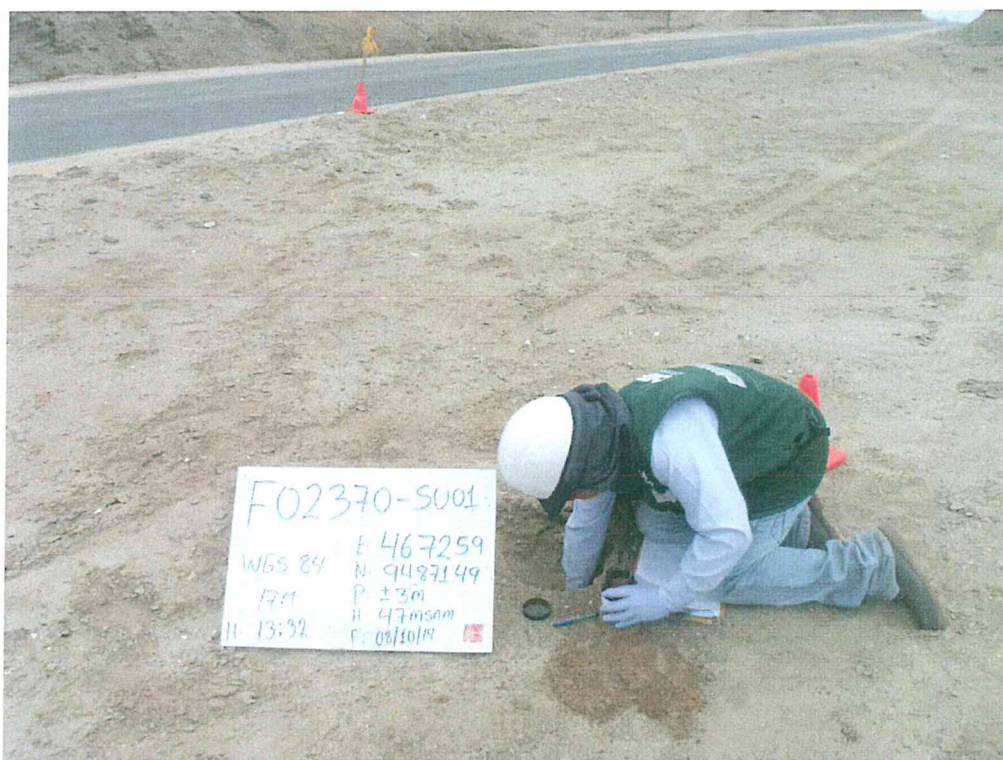
Fotografía N° 3. Toma de muestra de suelo en el punto F02370-SU01, ubicado aproximadamente a 0,3 m al oeste de la posible ubicación del Pozo T__37.
