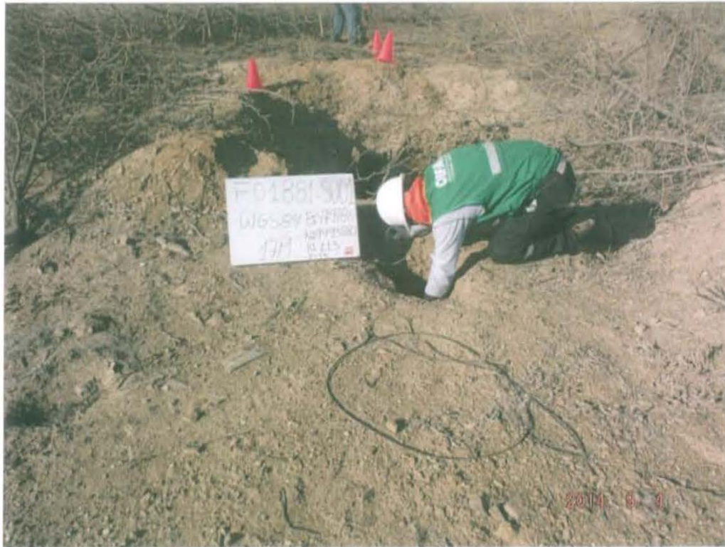
Fotografía N° 3. Muestra de suelo puntual a 2 m al suroeste del pozo.
