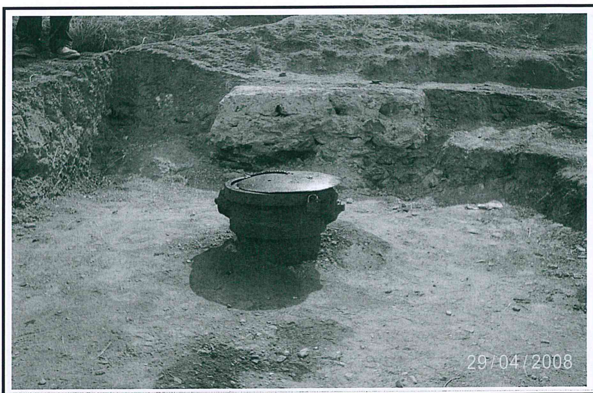
Foto 3. Vista del pozo Pirin "A". Se observa tapa y candado, el cual fue manipulado para extraer petróleo en forma artesanal causando impacto al suelo. Se excavó alrededor del forro
