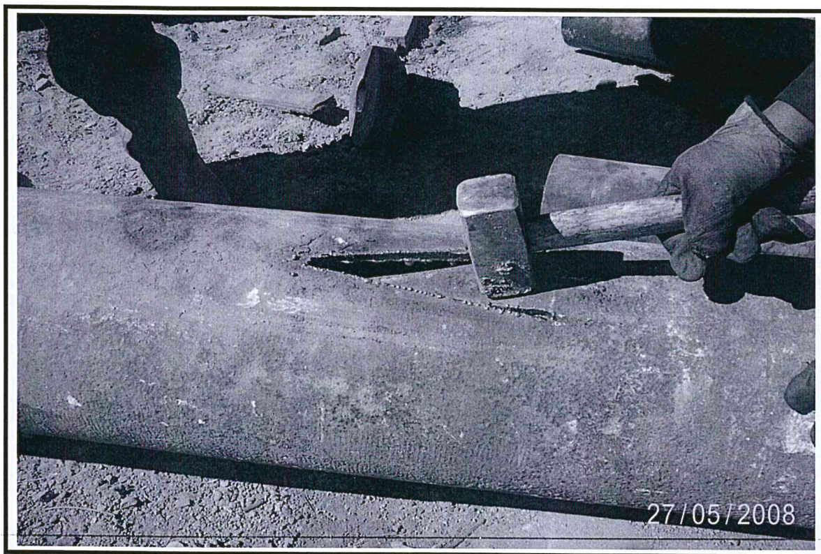
Foto 9. Confeccionando canasta tipo espiga de 10 3/4" x 3 mts, para ser bajado al interior del pozo
