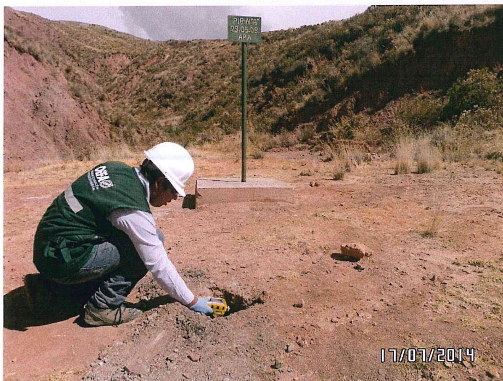
Fotografía N° 4. Mediciones en el F00759-VA02, se realizó la medición en un agujero de 30 cm de profundidad a 3m de distancia del pozo.
