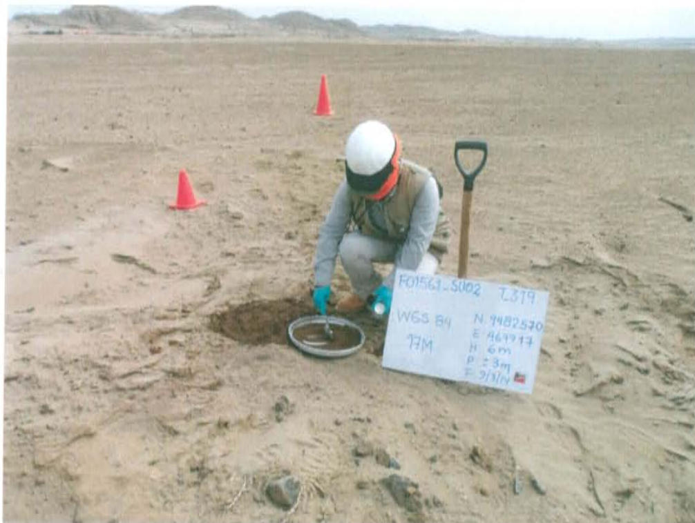
Fotografía N° 4. Toma de muestra de suelo en el punto F01561-SU02.
