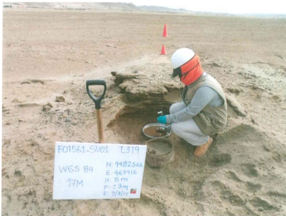
Fotografía N° 3. Toma de muestra de suelo en el punto F01561-SU01.
