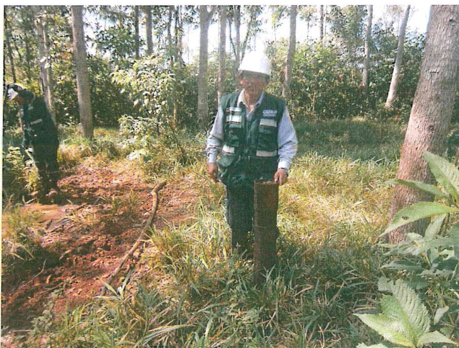
Fotografía N° 2. Cercano a la ubicación del pozo se observa una tubería cortada que se presume sea parte de la estructura del pozo.
