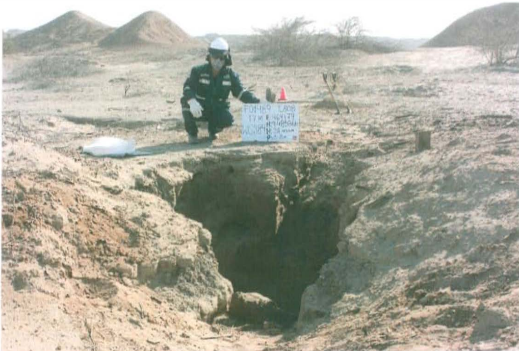
Fotografía N° 2. El pozo se encuentra en un hoyo de aproximadamente 1,5 m de profundidad.
