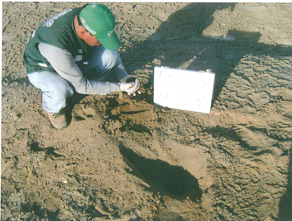
Fotografía N° 3. Toma de muestra de suelo en el punto F00057-SU01.
