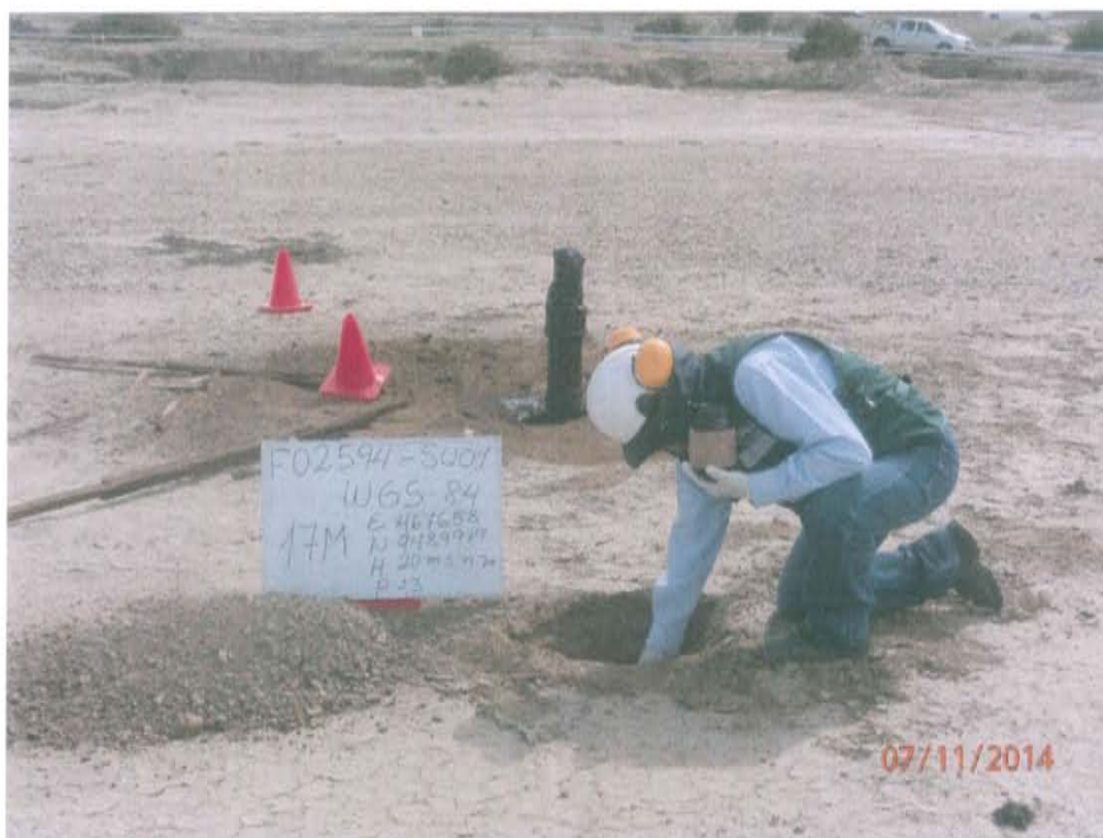
Fotografía N° 3. Toma de muestra de suelo en el punto F02594-SU01, ubicado a 0,59 m aproximadamente del Pozo T4940.
