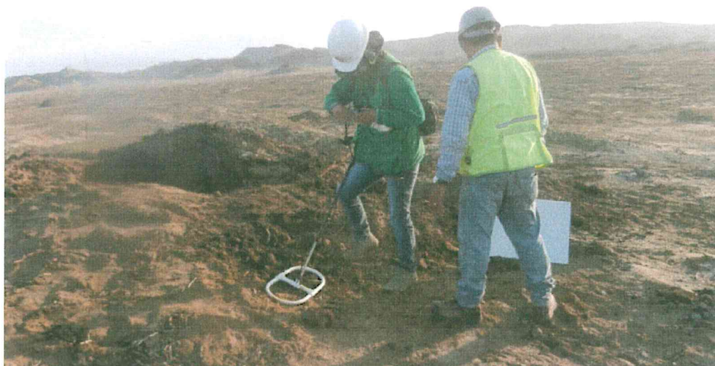
Fotografía N° 1. Búsqueda del pozo T_176 usando el detector de metales.
