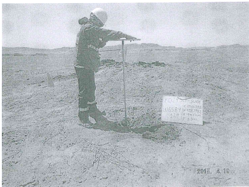
Fotografía N° 1. Toma de muestra de suelo en el punto F02950-SU01, ubicado a 4 m aproximadamente del Pozo T_176.
