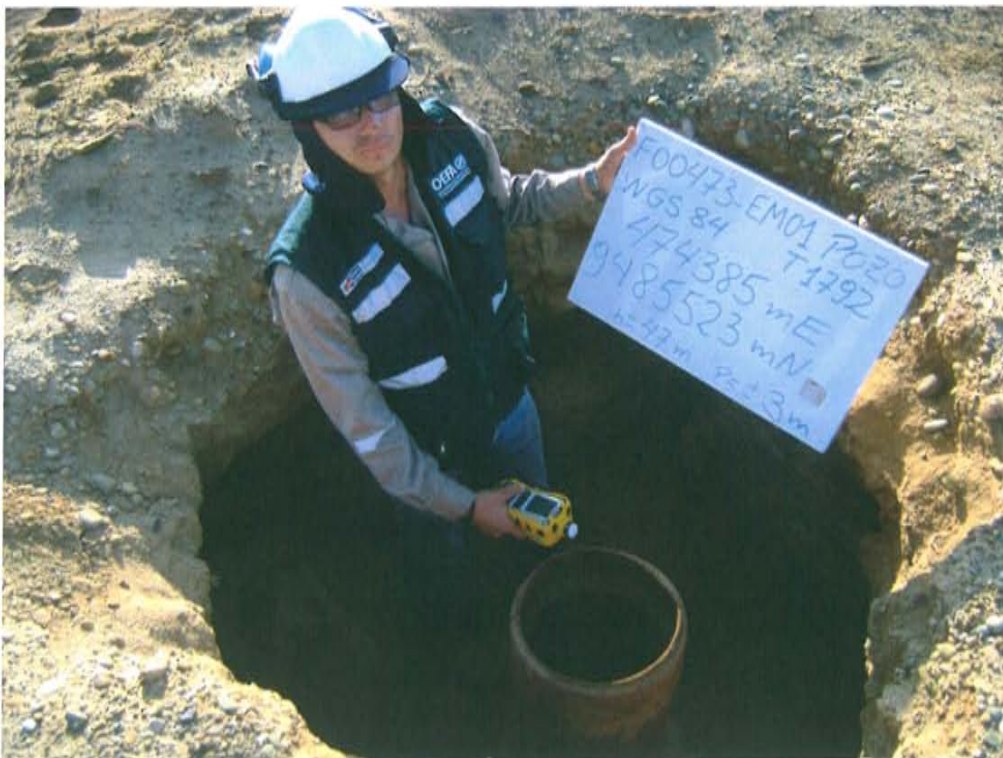
Fotografía N° 4. Medición en el punto F00473-EM01, ubicado en la fuente de emisión en boca del Pozo T1792.
