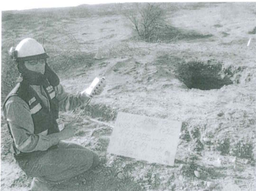
Fotografía N° 2. Medición en el punto F00473-EM02, ubicado a 3 m del Pozo T1792 a sotavento
