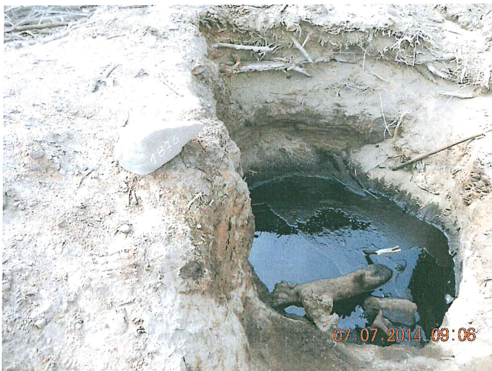
Fotografía N° 2. Vista panorámica del área donde se encuentra el pozo (T1876), con afloramiento de hidrocarburos y burbujeo.
