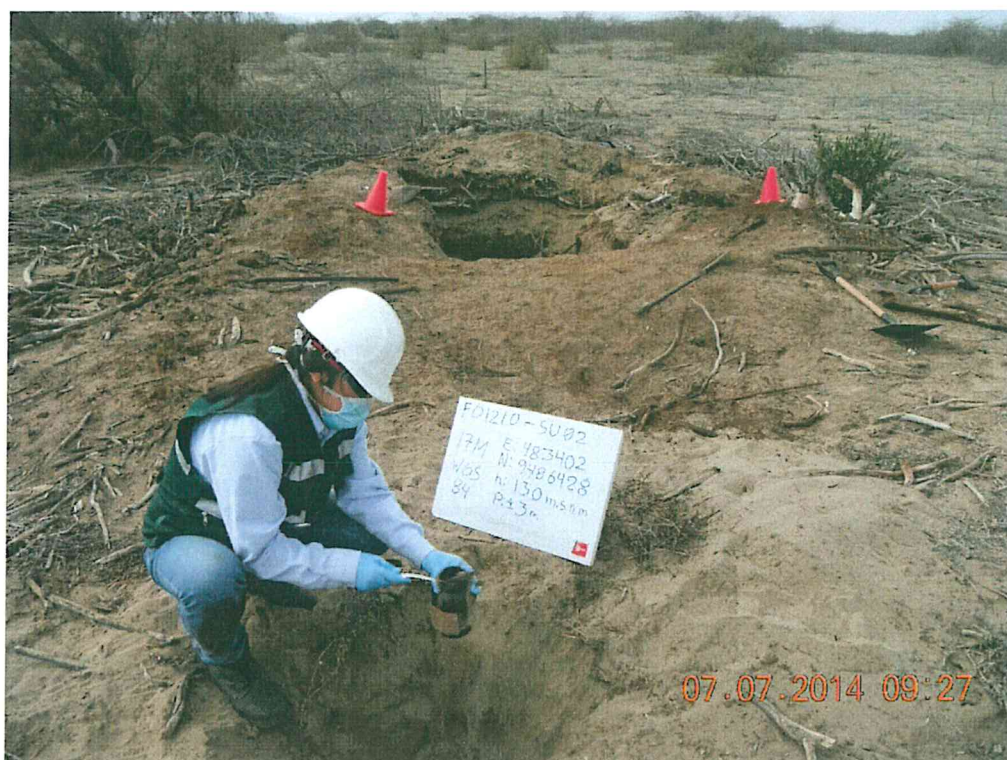
Fotografía N° 5. Toma de muestra de suelo en el punto F01210-SU02, ubicado a 5,3 m del pozo (T1876) sumergido en el fluido.
