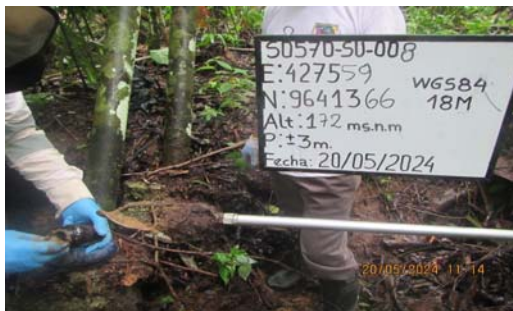
Toma de muestra de suelo en el punto S0570-SU-008, entre 0,00 m y 0,20 m de profundidad. Se observó suelo limo arcilloso de color marrón, húmedo y sin indicios organolépticos de
