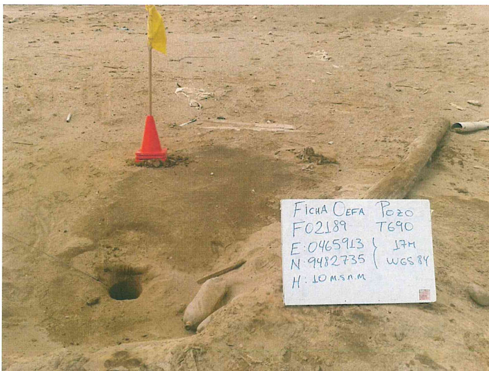
Fotografía N° 1. Vista pozo T_690 ubicado en una planicie, se observa el casing abierto al ambiente.
