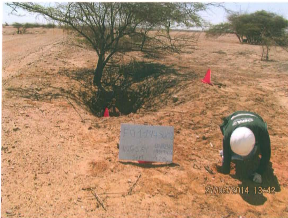
Fotografía N° 4. Toma de muestra de suelo en el punto F01147-SU02, ubicado a 3,8 m aproximadamente al sureste del Pozo T 4974.
