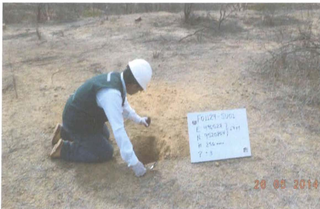
Fotografía N° 3. Toma de muestra de suelo en el punto F01129-SU01, ubicado a 4,2 m aproximadamente del Pozo.
