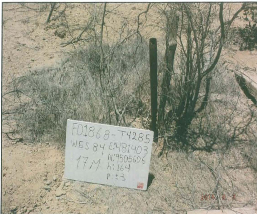
Fotografía N° 1. No se observó cabezal ni casing a nivel superficial, en su lugar se tiene un tubo de reducción de 2 plg de diámetro que se encuentra cortado y que sobresale una altura de 0,85 m.
