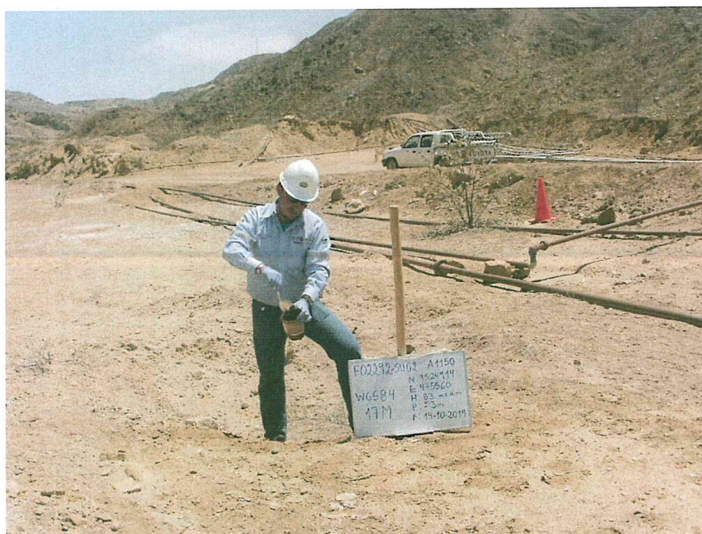
Fotografía N° 4. Toma de muestra de suelos F02292-SU02 a 10m de distancia del pozo.
