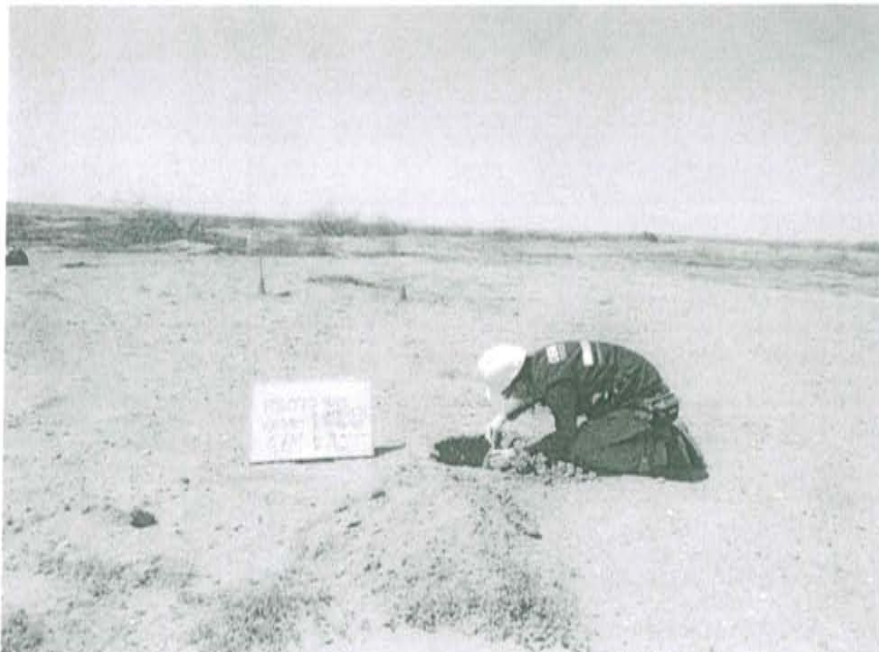
Fotografía N° 2. Toma de muestra de suelo en el punto F02070-SU02, ubicado a Noroeste del pozo y a 9,0 m aproximadamente del Pozo T2589
