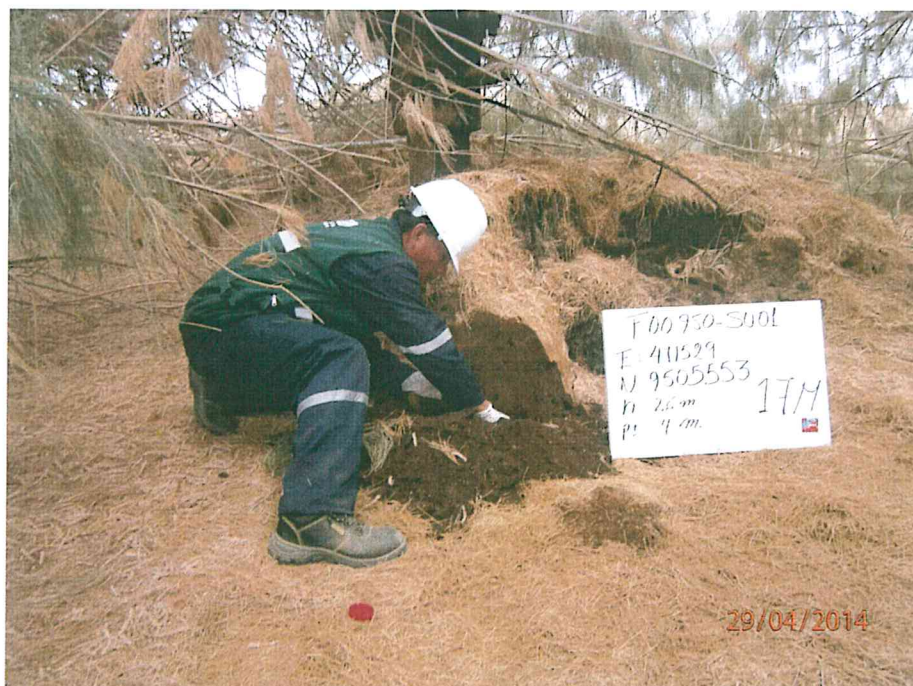
Fotografía N° 3. Toma de muestra de suelo en el punto F00950-SU01, ubicado a 1 m al este del Pozo L2068 y a una profundidad de 0,25 m a 0,3 m de la superficie del suelo.
