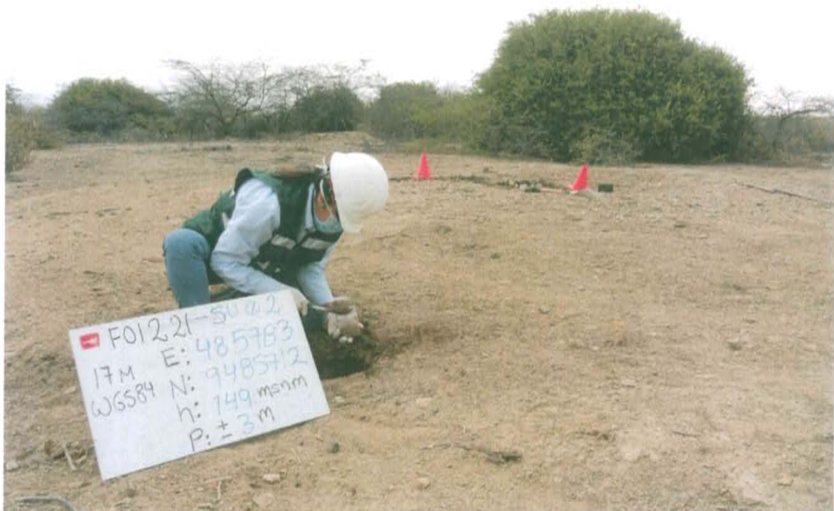
Fotografía N° 04.- Toma de muestra de suelo en el punto F01221-SU02, ubicado a 5,2 m aproximadamente del Pozo T2014.
