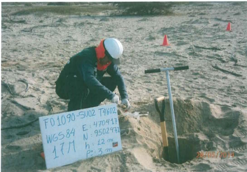
Fotografía N° 4. Vista del recojo de la muestra de suelo realizado por el evaluador en el área de ubicación del pozo en el punto F01090-SU02.
