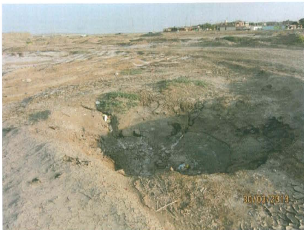
Fotografía N° 1. Vista de la posible ubicación del pozo, se aprecia suelo contaminado por hidrocarburos en el interior del hoyo.
