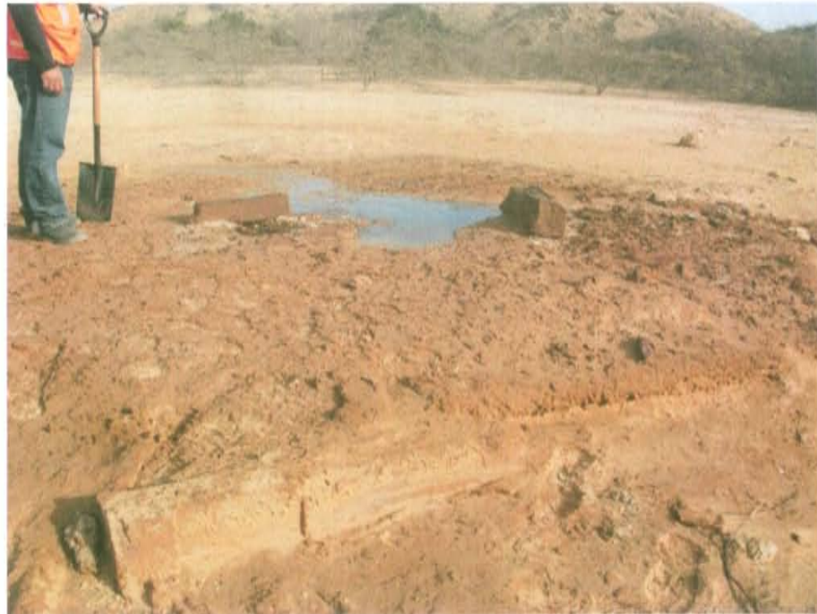
Fotografía N° 1. Vista del Pozo L_1665, a nivel del suelo se observa afloramiento y burbujeo.
