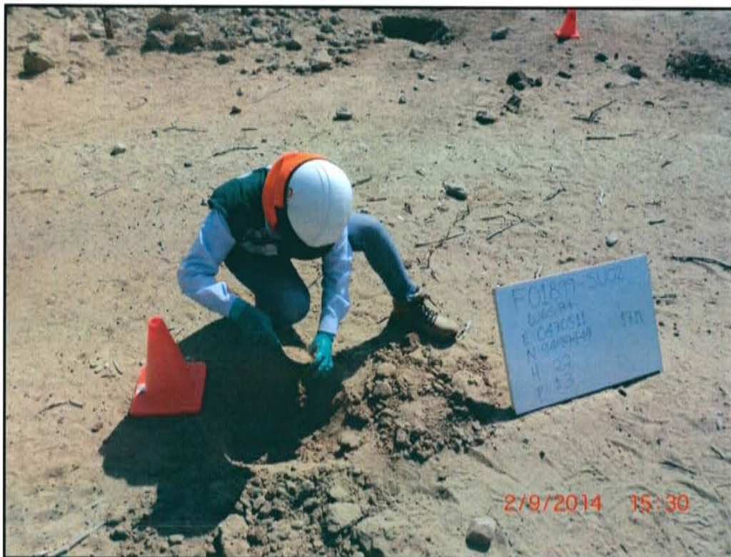
Fotografía N° 4. Toma de muestra en el punto F01899-SU02, ubicado a 5 m de distancia de la posible ubicación del pozo T3610.
