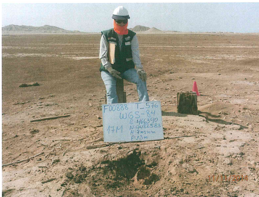
Fotografía N° 1. Se observa el casing corroído al ras de la superficie.
