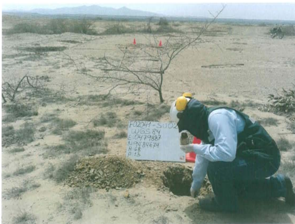
Fotografía N° 4. Toma de muestra de suelo en el punto F02041-SU02, ubicado a 7 m aproximadamente del Pozo T3168.
