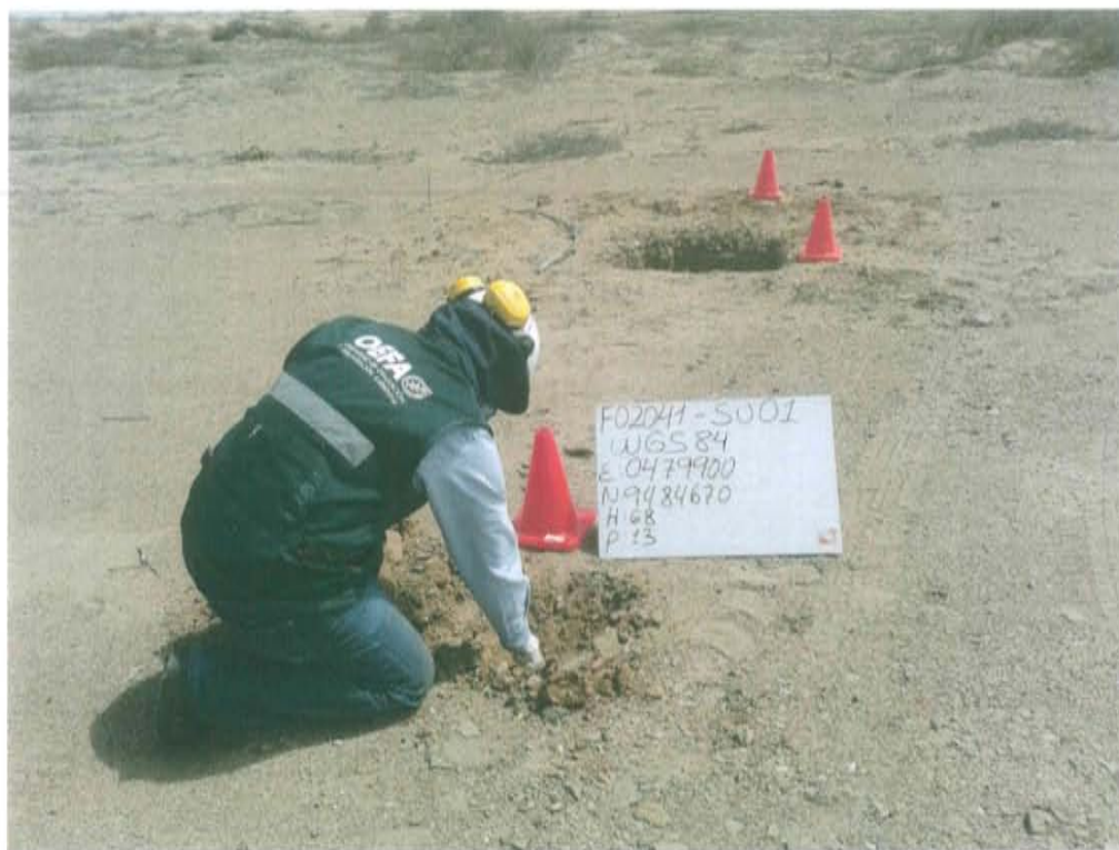
Fotografía N° 3. Toma de muestra de suelo en el punto F02041-SU01, ubicado a 3,5 m aproximadamente del Pozo T3168.
