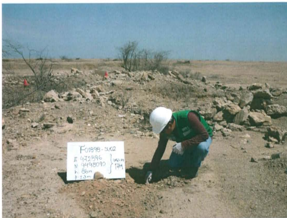
Fotografía N° 4. Toma de muestra de suelo en el punto F01898-SU02 ubicado a 10,5 m al este del Pozo T3855.
