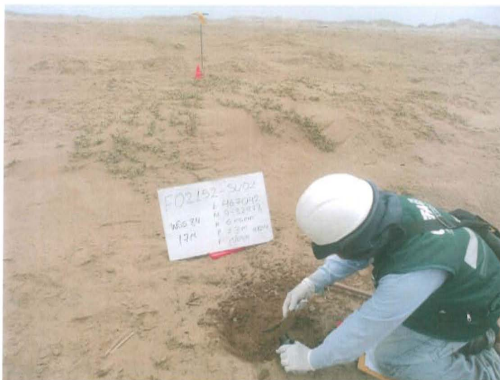
Fotografía N° 3. Toma de muestra de suelo en el punto F02152-SU02, ubicado aproximadamente a 9 m, al noreste del Pozo T_246.
