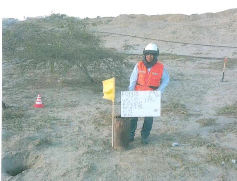
Fotografía N° 1. Identificación del pozo inactivo con código PERUPETRO L__55. Presenta casing sin elementos de cierre en la superficie.
