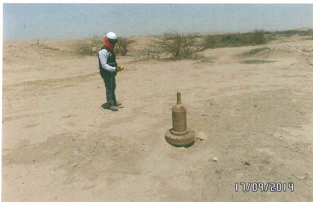
Fotografía N° 4. Medición en alrededores, en un recorrido en el área circundante al pozo en un radio de 1 m, con una duración de 10 minutos.
