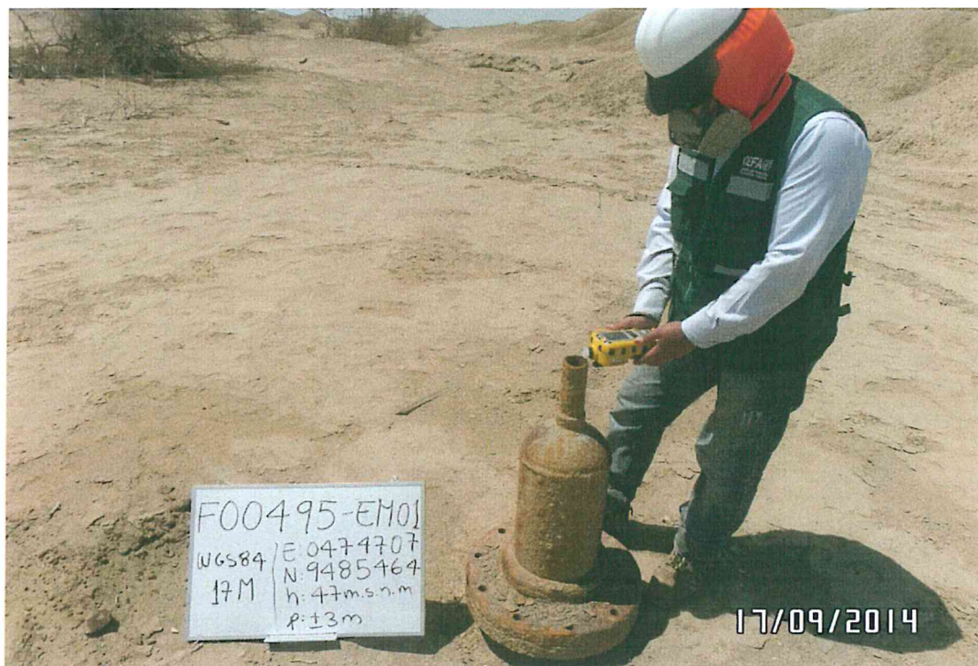
Fotografía N° 3. Medición de emisiones gaseosas fugitivas en el punto F00495-EM01, ubicado en la fuente de emisión en boca del Pozo T2688.
