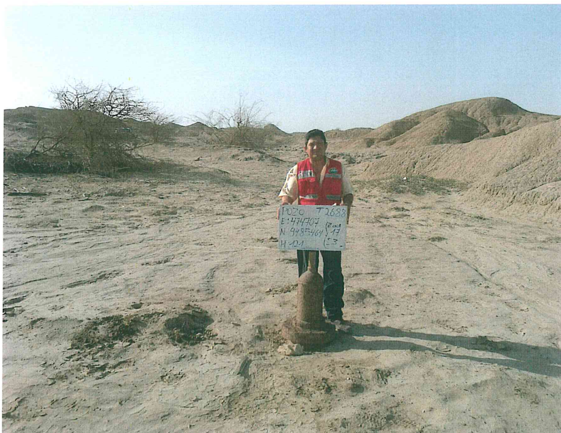
Fotografía N° 2. Vista del pozo petrolero inactivo T2688, se observó brida con tubería de reducción corroída.
