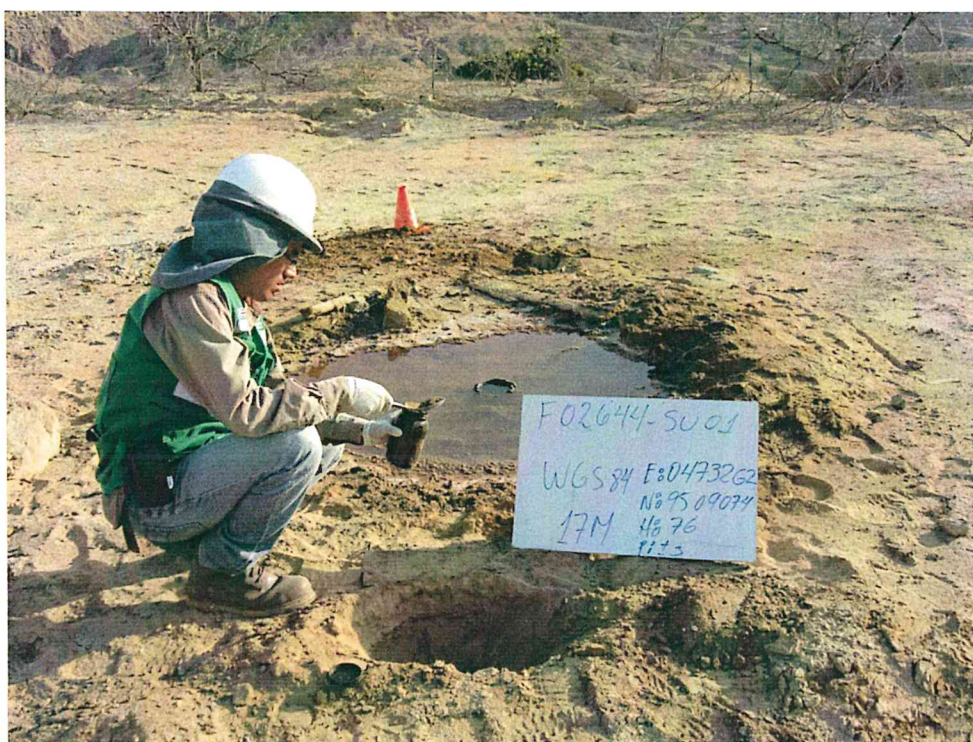
Fotografía N° 3. Muestra puntual de suelo tomada a 1 m en dirección Norte del Pozo L10164.
