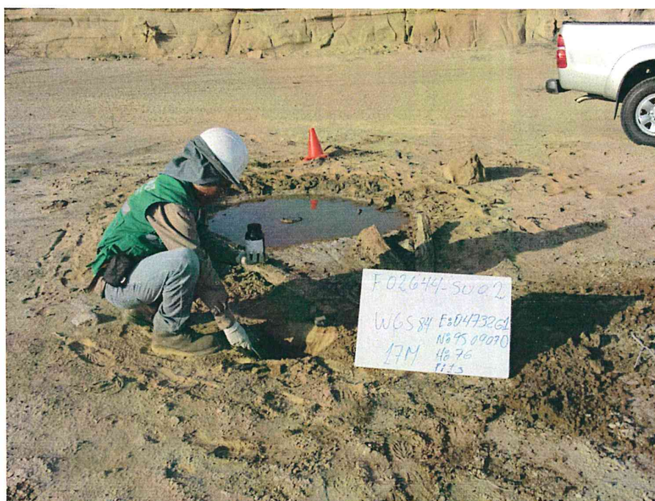
Fotografía N° 4. Muestra puntual de suelo tomada a 2 m en dirección Sur del Pozo L10164.
