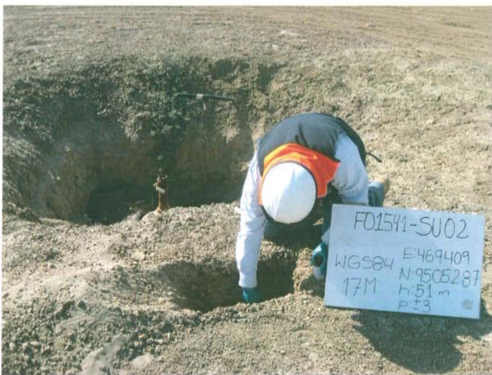
Fotografía N° 3. Toma de muestra de suelo en el punto F01541-SU02, ubicado aproximadamente a 2 m del Pozo L_538.
