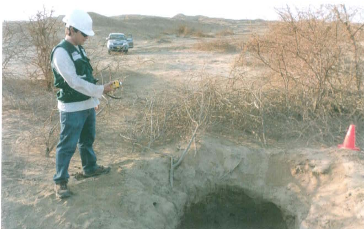
Fotografía N° 6. Mediciones en el F00475-VA01, se realizó en un recorrido en el área circundante alrededor del Pozo T2609 en un radio de 1 m, con una duración de 10 minutos.
