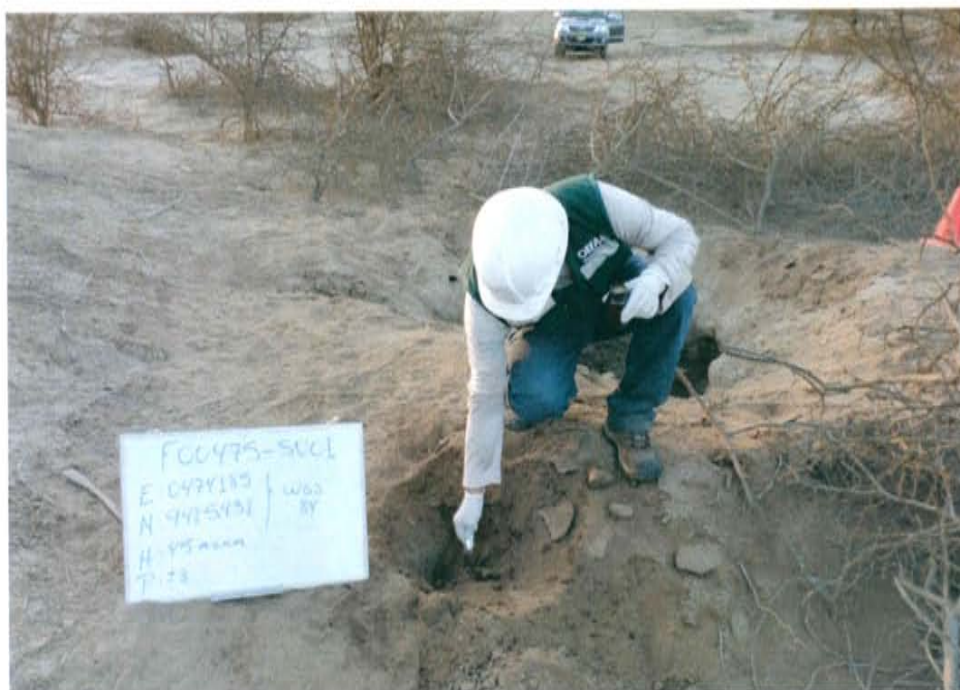
Fotografía N° 3. Toma de muestra de suelo en el punto F00475-SU01, ubicado a 2,2 m aproximadamente del pozo T2609.
