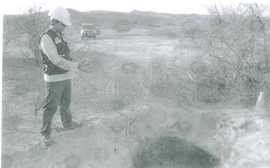
Fotografía N° 2. Mediciones en el F00475-VA01, se realizó en un recorrido en el área circundante alrededor del Pozo T2609 en un radio de 1 m, con una duración de 10 minutos.
