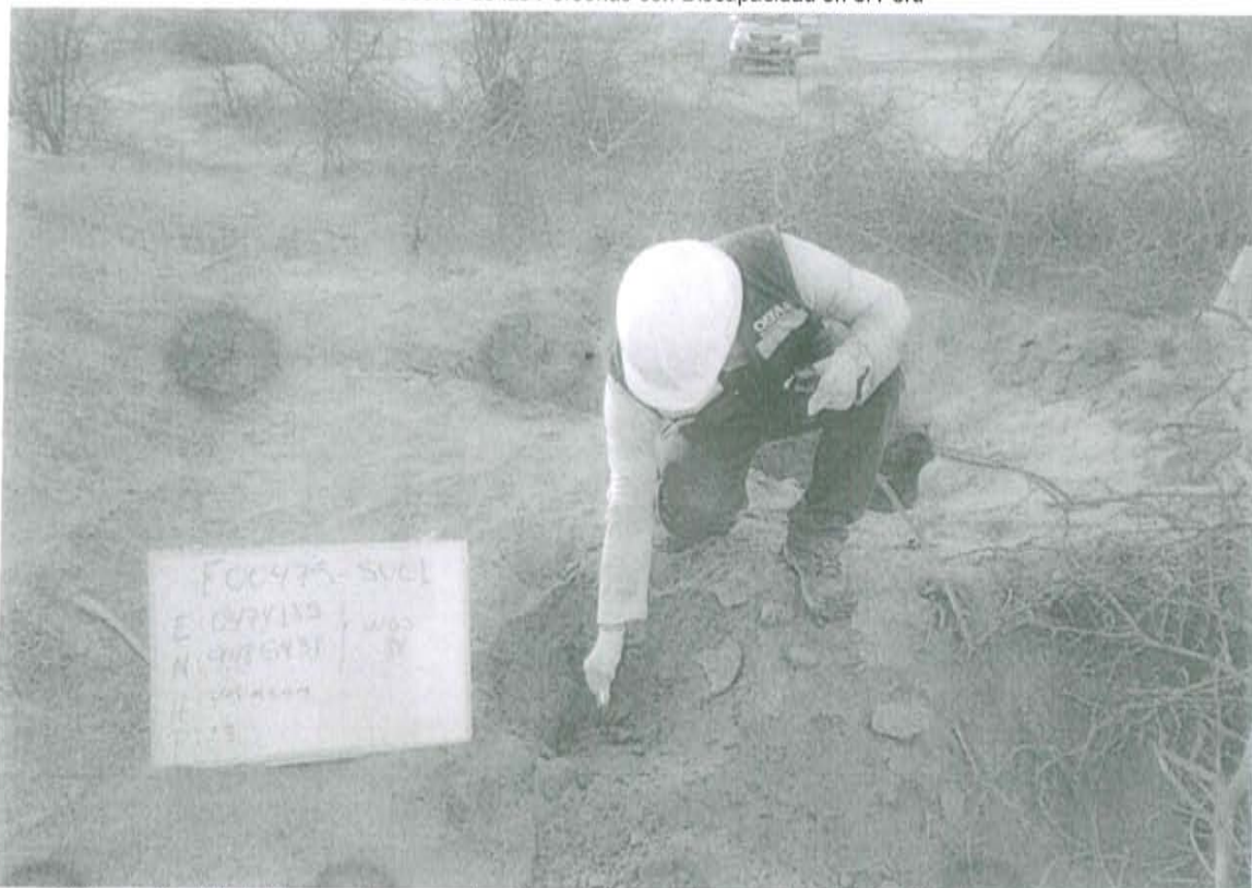
Fotografía N° 1. Toma de muestra de suelo en el punto F00475-SU01, ubicado a 2,2 m aproximadamente del pozo T2609.
