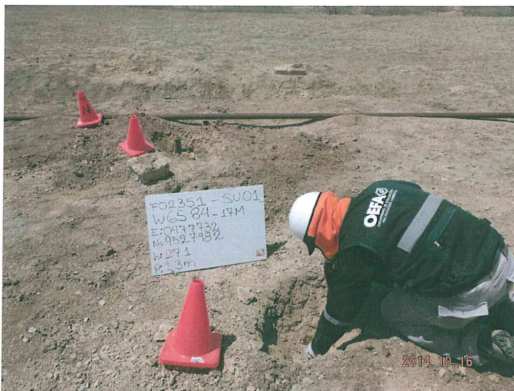
Fotografía N° 3. Toma de muestra de suelo en el punto F02351-SU01, ubicado a 2 m de distancia aproximadamente del Pozo A_305.
