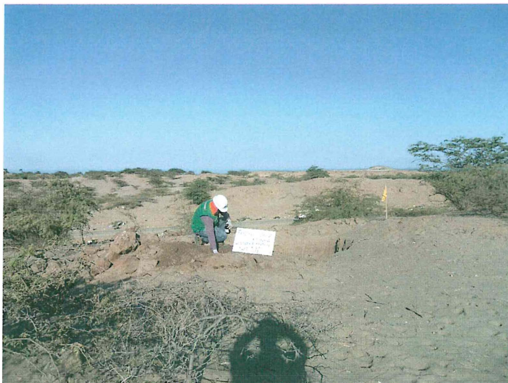
Fotografía N° 4. Toma de muestra de suelo en el punto F02422-SU02 ubicado a 8 m de la posible ubicación del casing de pozo.
