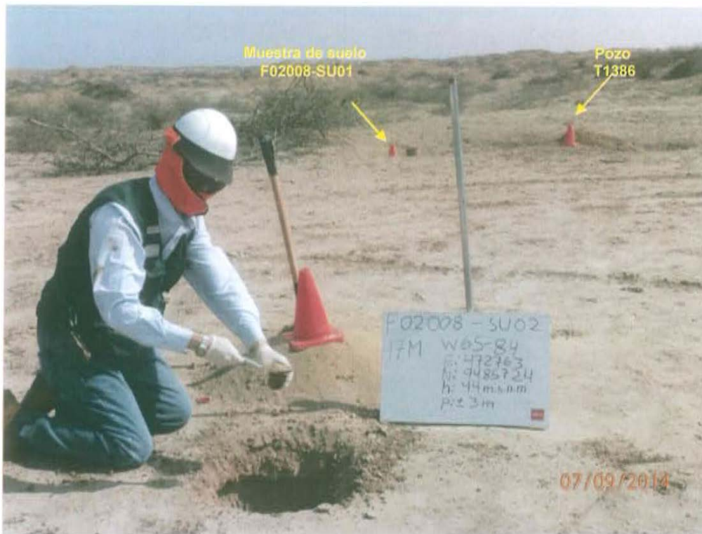
Fotografía N° 3. Toma de muestra de suelo en el punto F02008-SU02, ubicado a 9 m aproximadamente del Pozo T1386
