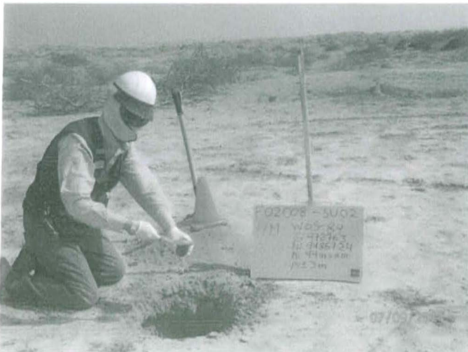
Fotografía N° 2. Toma de muestra de suelo en el punto F02008-SU02, ubicado a 9 m aproximadamente del Pozo T1386.
