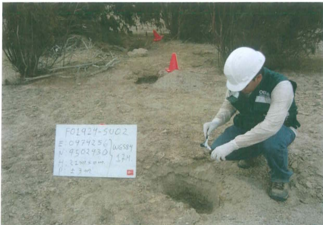
Fotografía N° 04.- Toma de muestra de suelo en el punto F01924-SU02, ubicado a 5,8 m aproximadamente del Pozo T33734.
