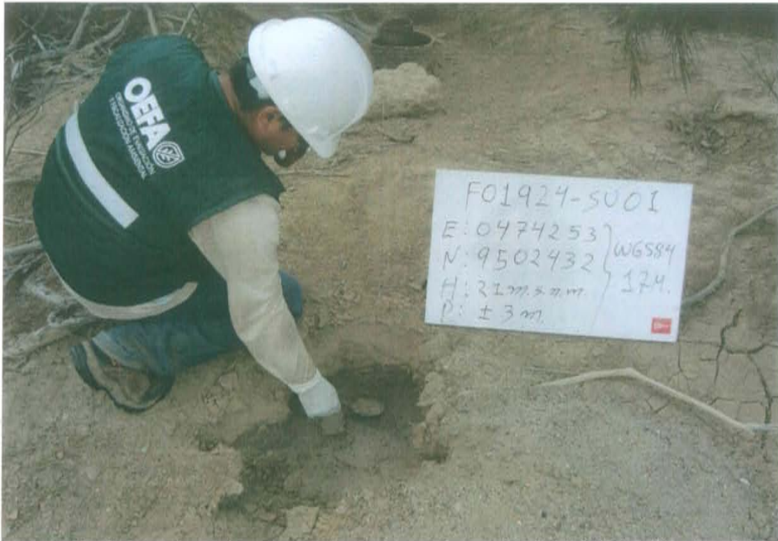
Fotografía N° 03.- Toma de muestra de suelo en el punto F01924-SU01, ubicado a 2,9 m aproximadamente del Pozo T3734.
