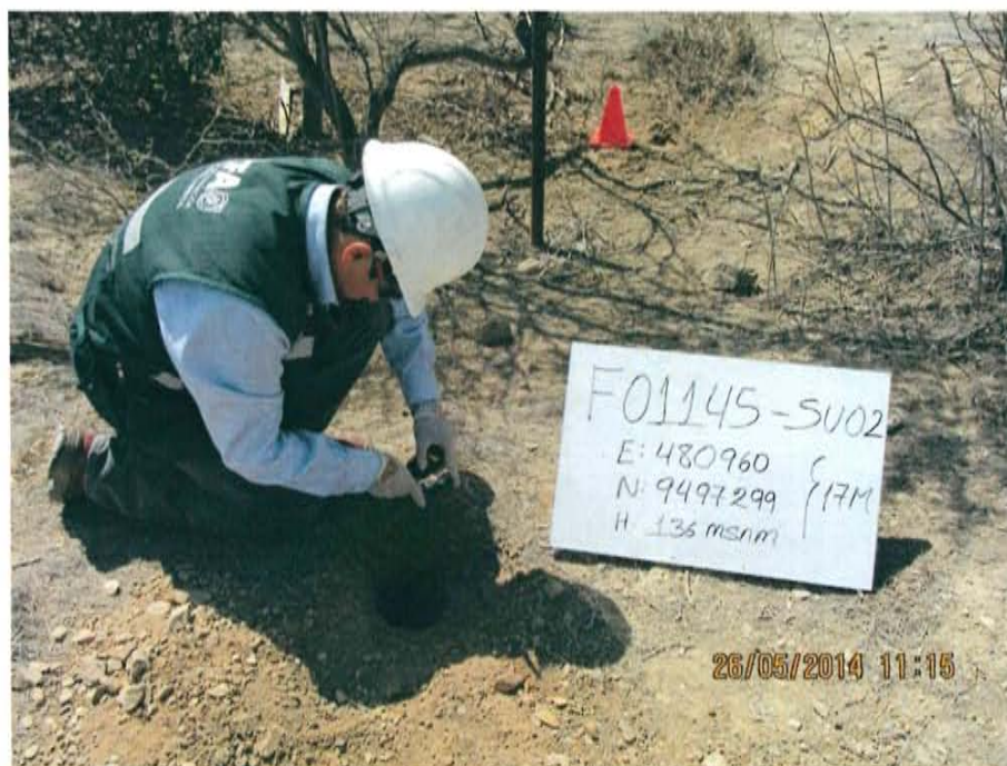
Fotografía N° 4. Muestra de suelo en el punto F01145-SU02, ubicado a 2,25 m aproximadamente del Pozo T 3656.
