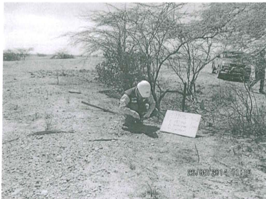
Fotografía N° 2. Toma de muestra de suelo en el punto F01145-SU02, ubicado a 2,25 m aproximadamente del Pozo T 3656.
