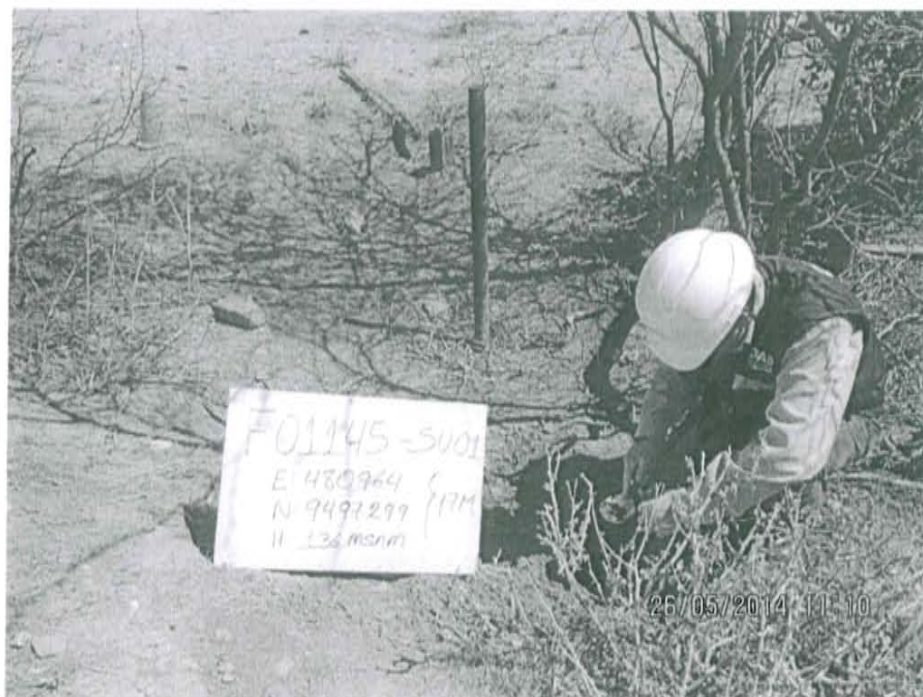
Fotografía N° 1. Toma de muestra de suelo en el punto F01145-SU01, ubicado a 1,36 m aproximadamente del Pozo T 3656.
