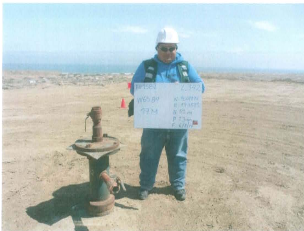
Fotografía N° 1. Se observa el cabezal del pozo compuesto por una brida y dos (02) válvulas de reducción de donde emanan emisiones gaseosas.
