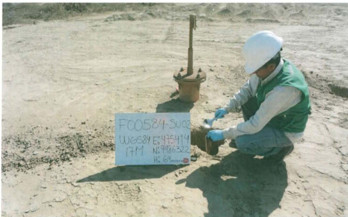
Fotografía N° 04.- Toma de muestra de suelo en el punto F00584-SU02, ubicado a 1 m aproximadamente del pozo T2299.
