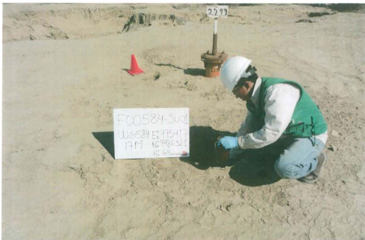
Fotografía N° 03.- Toma de muestra de suelo en el punto F00584-SU01, ubicado a 2 m aproximadamente del pozo T2299.
