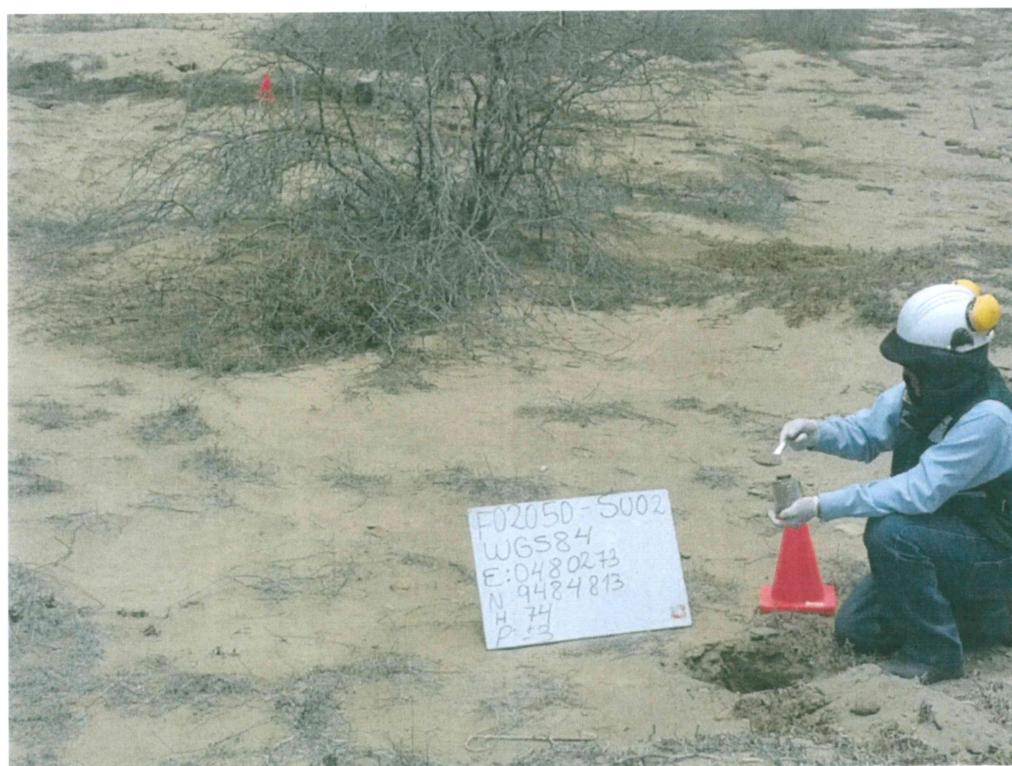
Fotografía N° 4. Toma de muestra de suelo en el punto F02050-SU02, ubicado a 8,5 m aproximadamente del Pozo T2885.
