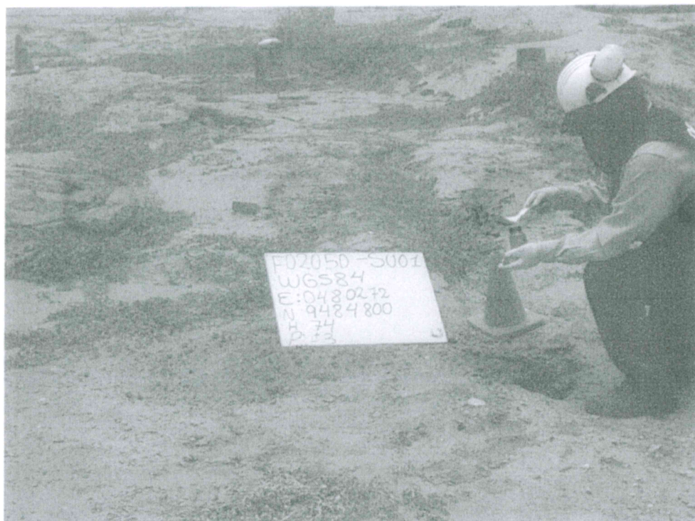
Fotografía N° 1. Toma de muestra de suelo en el punto F02050-SU01, ubicado a 4,5 m aproximadamente del Pozo T2885.
