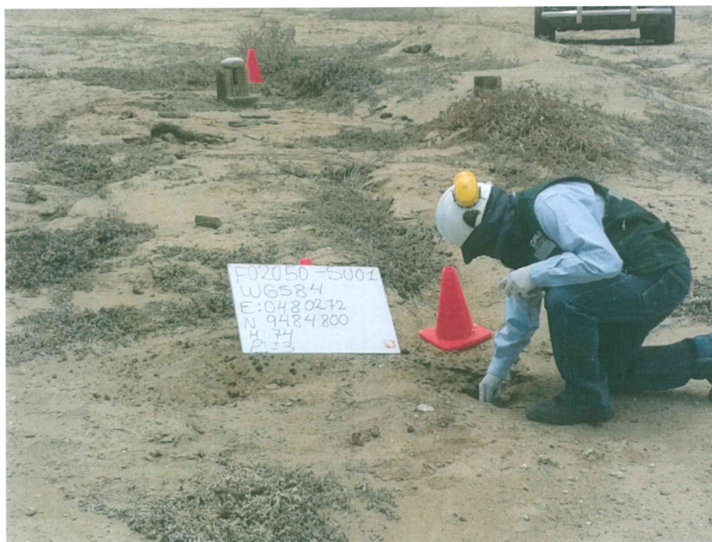
Fotografía N° 3. Toma de muestra de suelo en el punto F02050-SU01, ubicado a 4,5 m aproximadamente del Pozo T2885.
