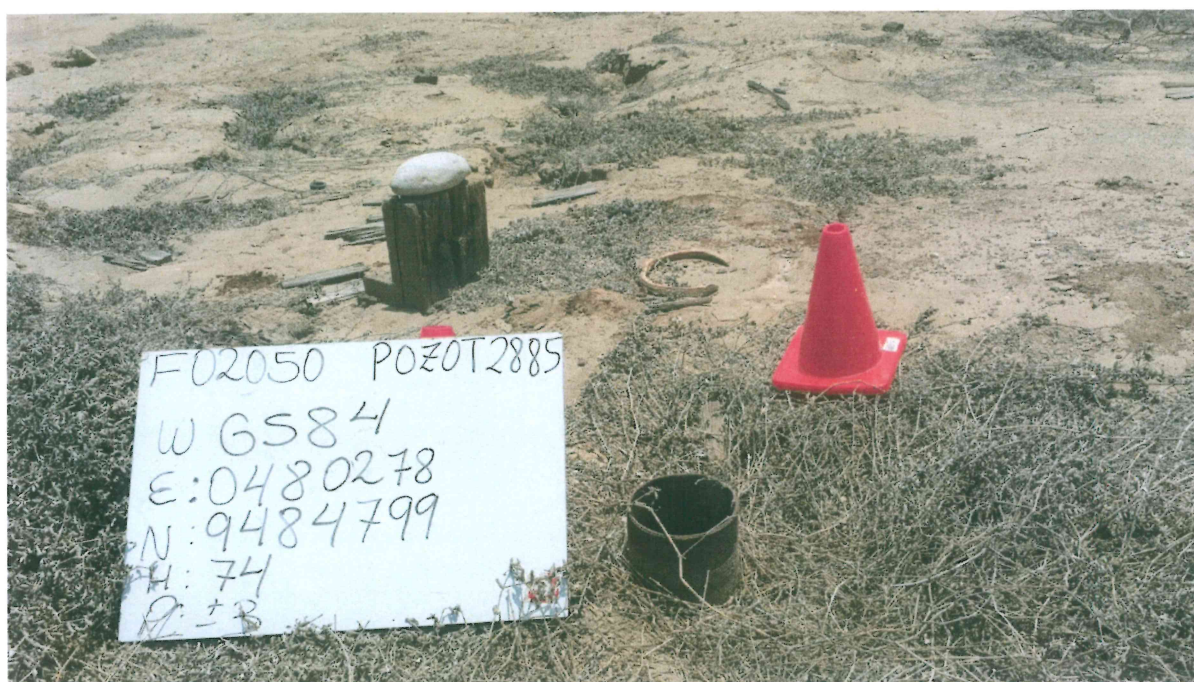
Fotografía N° 1. Pozo inactivo con código PERUPETRO T2885 donde se observa el casing que sobresale una altura aprox. de 0,18 m sobre el nivel de la superficie.
