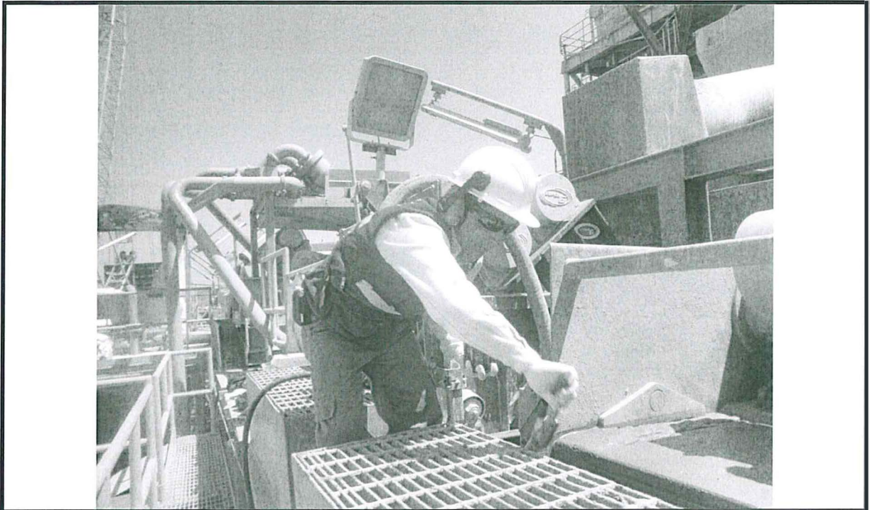
Fotografía N° 5, Toma de muestras de ripios de perforación del pozo A26D, en los sheikers (Zaranda) de la barcaza Don Fernando.
