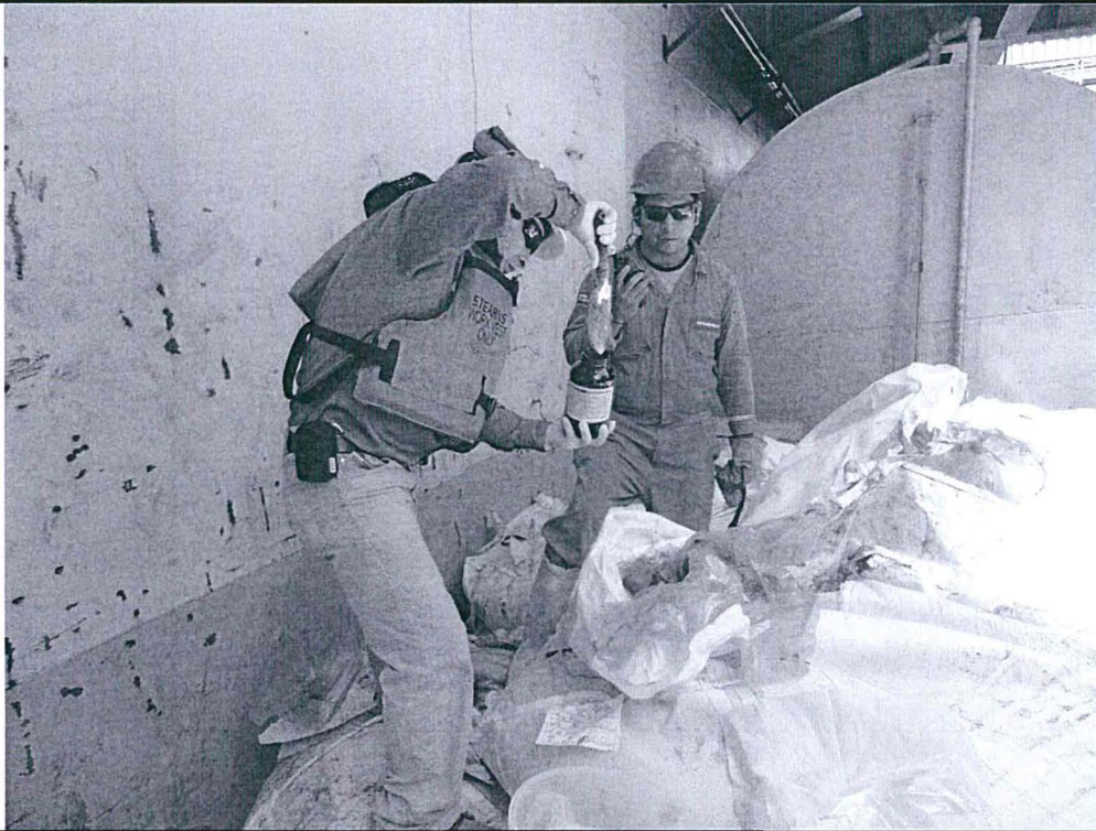
Fotografía N° 7, Muestreo de lodo de la separación Dewatering, en las sacas almacenadas en la sala de Big Bag.
