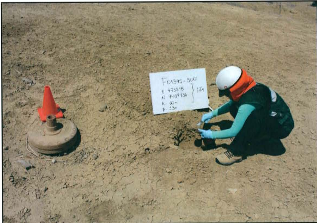
Fotografía N° 3. Toma de muestra en el punto F01345-SU01, ubicado a 1,3 m de distancia del casing del pozo T 2497 a una profundidad de 0,3 m de la superficie del suelo.
