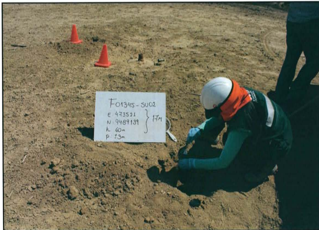
Fotografía N° 4. Toma de muestra en el punto F01345-SU02, ubicado a 3 m de distancia del casing del pozo T 2497 a una profundidad de 0,4 m de la superficie del suelo.
