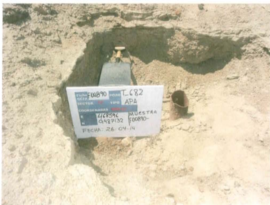
Fotografía N° 2. El casing sobresale 0,13 m sobre el nivel del suelo y se encuentra dentro de un hoyo.
