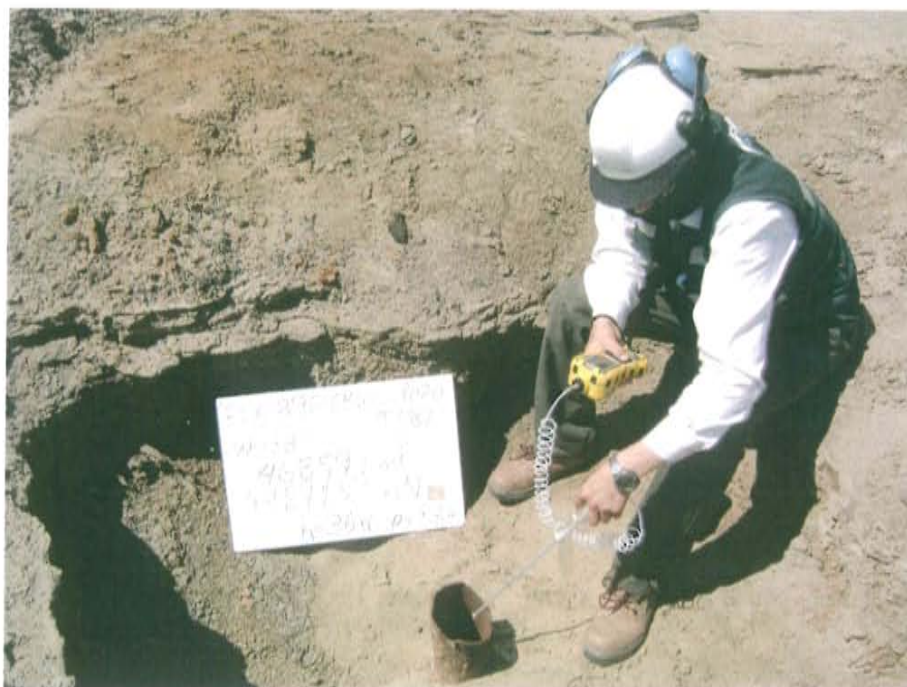
Fotografía N° 4. Medición de las emisiones gaseosas fugitivas en boca del Pozo T_682.
