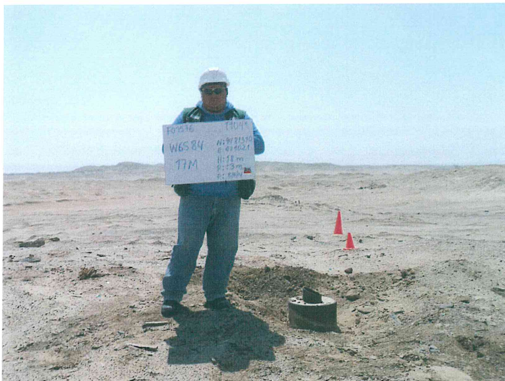
Fotografía N° 1. Se observa 2 casing concéntricos ambos cementadas en la sección anular donde el casing interior se encuentra abierto al ambiente.
