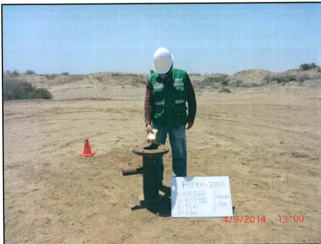
Fotografía N° 4. Medición de emisiones fugitivas en boca de Pozo L_369.
