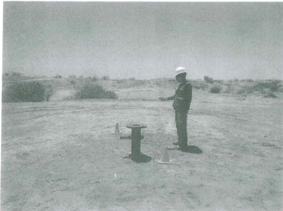
Fotografía N° 2. Mediciones en el punto F01904-VA01, se realizó en un recorrido en el área circundante alrededor del Pozo L_369 en un radio de 1 m.
