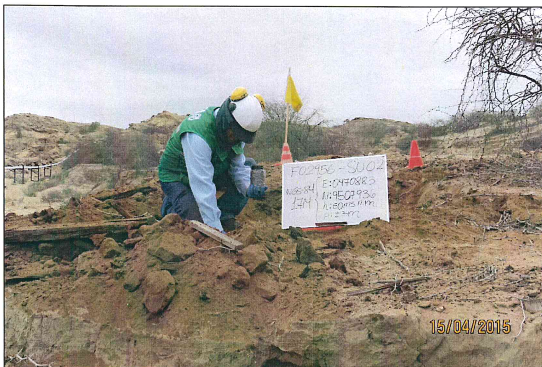
Fotografía N° 4. Toma de muestra de suelo en el punto F02956-SU02, ubicado a 2 m aproximadamente del Pozo L_424.
