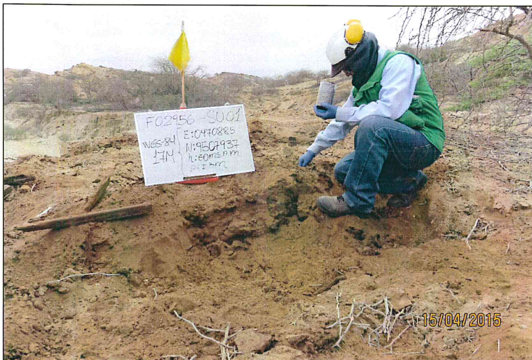
Fotografía N° 3. Toma de muestra de suelo en el punto F02956-SU01, ubicado a 0,5 m aproximadamente del Pozo L_424.
