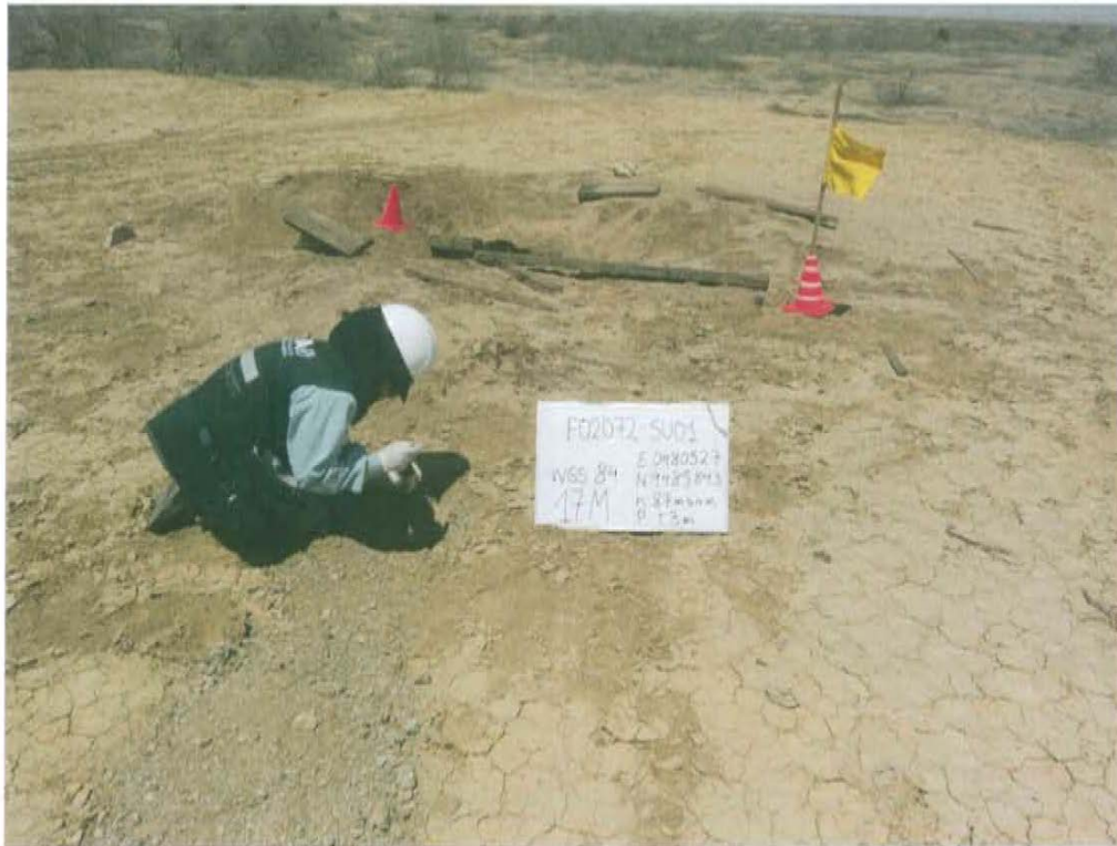
Fotografía N° 3. Toma de muestra de suelo en el punto F02072-SU01, ubicado a 3,2 m aproximadamente al noreste del Pozo T2644.
