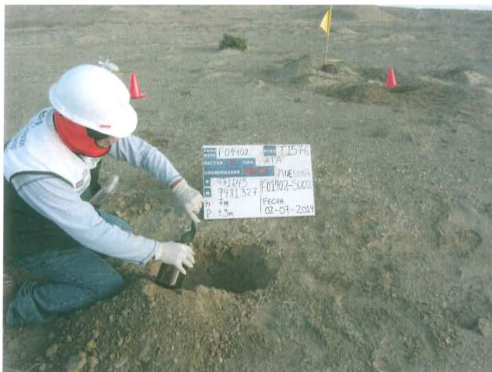
Fotografía N° 4. Toma de muestra de suelo en el punto F01402 -SU02, ubicado a 6 m del Pozo T1576.
