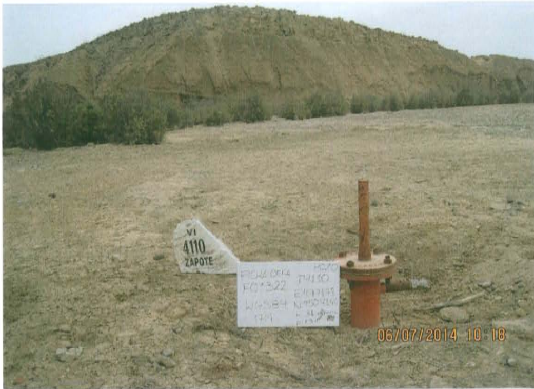
Fotografía N° 1. Identificación del pozo inactivo con código PERUPETRO T4110. Presenta extensión de tubo y brida con salida lateral sin válvulas.
